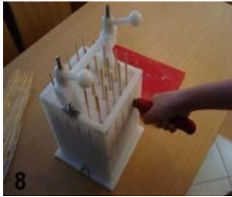
Mit einem Messer (dünn, lang, scharf) in den seitlichen Führungsschlitz gehen, an der Führungsrille der Deckelplatte ansetzen, das Messer auf der anderen Seite rausschauen lassen und langsam schneiden. Damit das Fleisch überall durchgeschnitten ist am besten Messer umdrehen und noch mal an der oberen Führungsrille lang schneiden. Auf diese Weise nehmen Sie sich jetzt einen Führungsschlitz nach dem anderen vor, an zwei nebeneinander liegenden Seiten.
